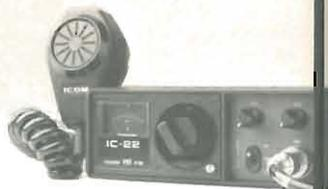
**Ricetrasmittenti su 2 m. in FM, tutti a VFO con sgancio automatico sui ponti a 600 KHz inferiore.**
